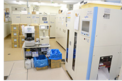
機械室。A剤とB剤を同時に溶解できる装置を備える
